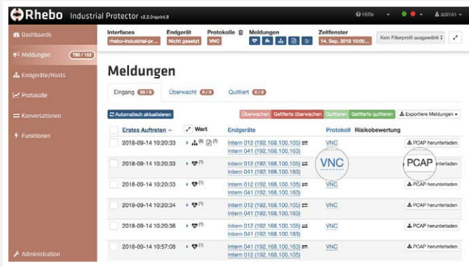
Für den Fernwartungszugang untypische Kommunikation über VNC wird in Echtzeit gemeldet und als PCAP gespeichert (Quelle: Digital Forensics)
